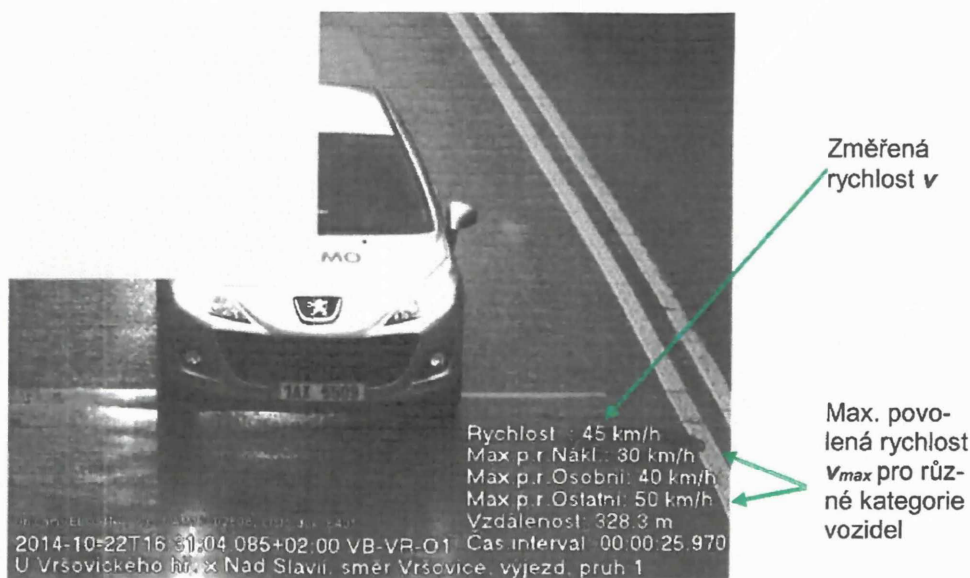
Obr. 7: Snímek vozidla při výjezdu z měřeného úseku s různými limity pro různé kategorie vozidel
